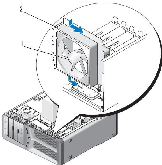
1 ventilateur du disque dur    2 bâti du ventilateur du disque dur
